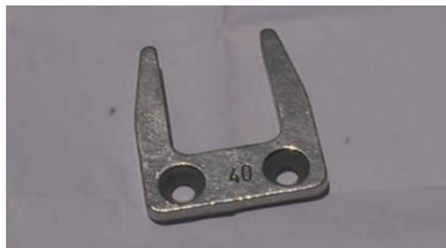
Figura 21. Calibrador fijo de grado 40.
